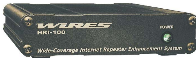
Figura 4—El equipo de control en el corazón del sistema Yaesu WIRES-II
